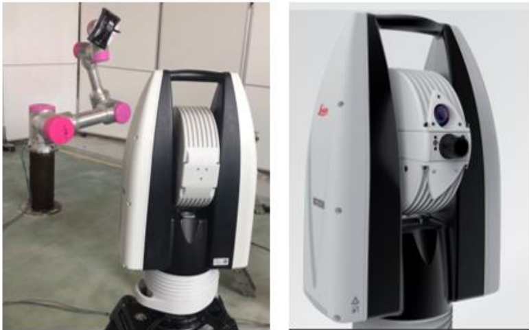
Hình 4.1 Bố trí thí nghiệm và hình ảnh mặt trước thiết bị đo của Leica
